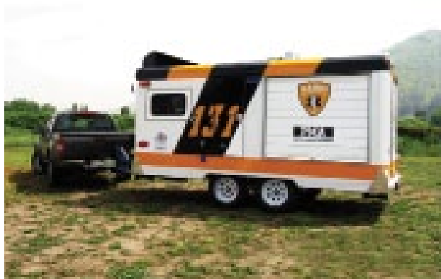
Figura 7. Carro que traslada el PMA del SAMU de la Región Metropolitana y que aporta un grupo electrógeno, dispositivos de comunicación y material para atención de víctimas.
