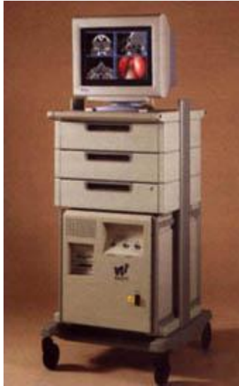
Figura 7. Navegador Instatrak 3000, que utiliza un sistema de seguimiento electromagnético de los instrumentos. Es una workstation Sun con sistema operativo Unix, implementada con el hardware de navegación. Recibe las imágenes de TAC o RM a través de la red Ethernet.
